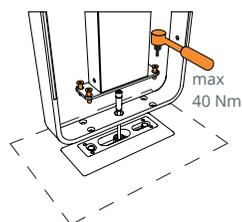
1. Anschlusskabel mit Stecker durch Bügel durchführen und in der Ladestation an Buchse-Verteilerbox anschließen.
