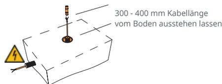
1. Kabel verlegen um die elektrische Ladestation an das Stromnetz anzuschließen.
